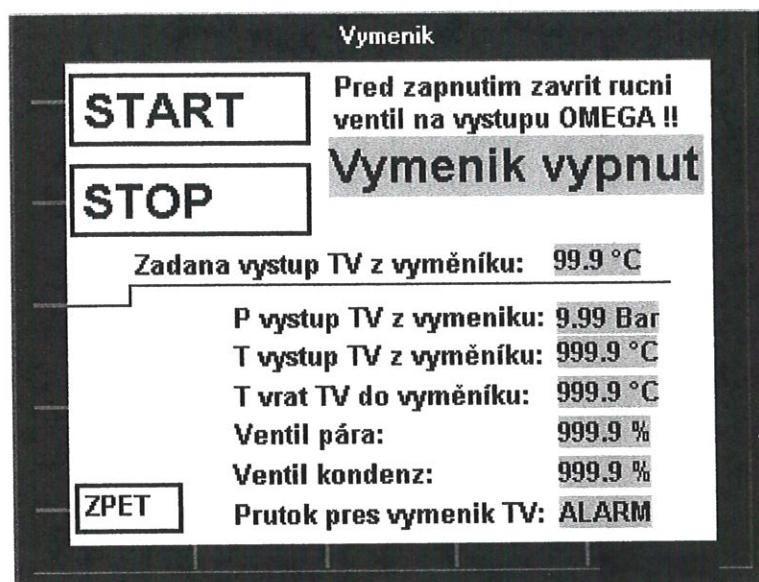
OBRÁZEK 1.3 Čelní pohled na panel řídicího systému tak jak je nainstalován na rozvaděči. Na displeji je obrazovka ovládání a informace o výměníku TV.
